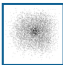
Rapporto di diluizione errato. Troppo diluente può produrre questa superficie dall'aspetto polveroso
